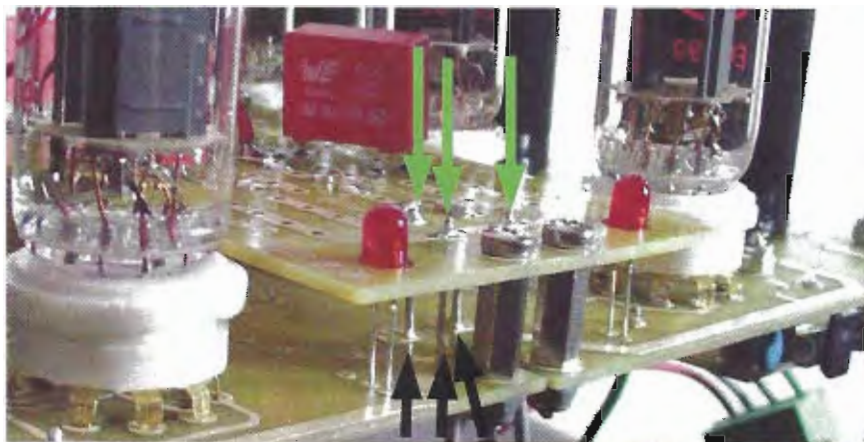
fig.3 - Particolare del collegamento tra le uscite OUTL*, OUTH* del ponte di potenza ed il filtro di uscita.
